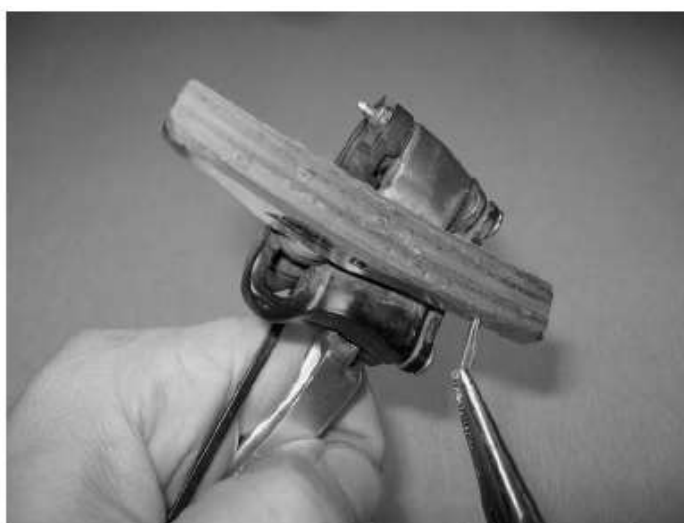
Estrazione della coppia di fermo e del pattino usurato
