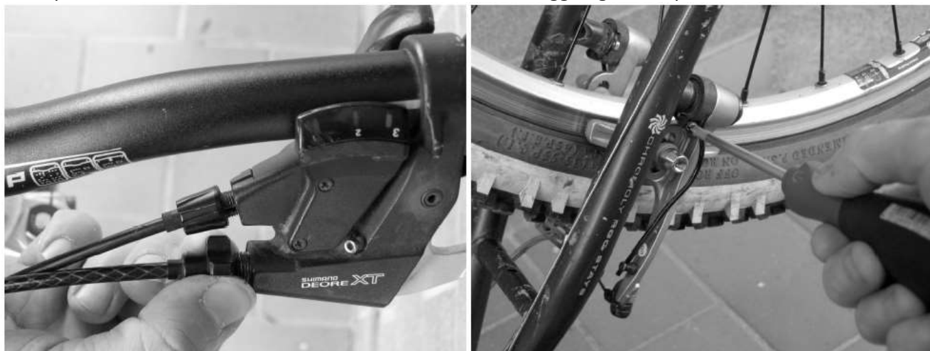
Regolazione del cavo del freno e della posizione del corpo freno
