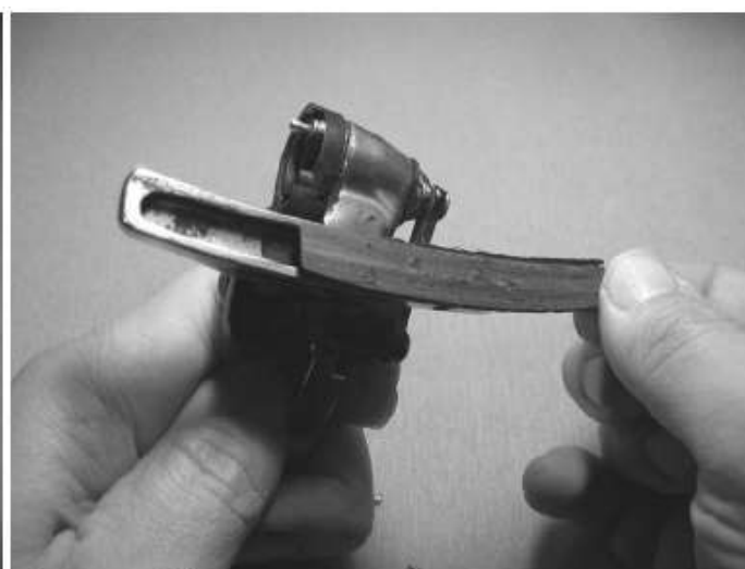
Estrazione della coppia di fermo e del pattino usurato
